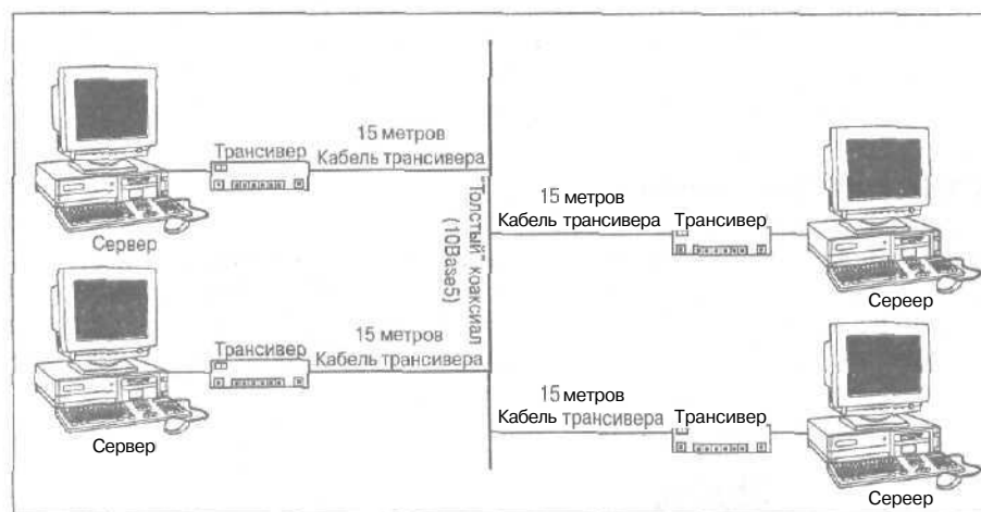
Рис. 7.3. Кабели трансивера сети 10Base5 могут иметь протяженность до 15 метров
