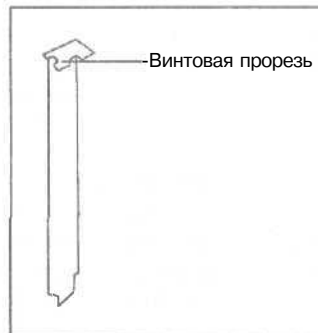
Рис. 6.3. Заглушки закрывают пустые гнезда и защищают компьютер от пыли и грязи
